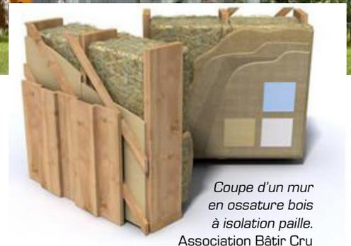
Coupe d'un mur en ossature bois à isolation paille.
