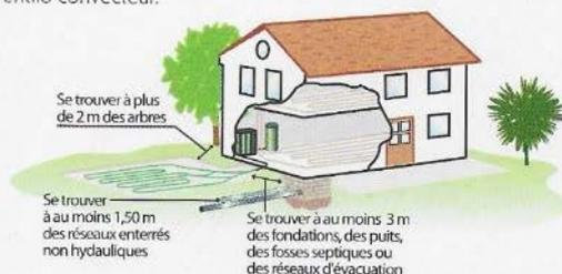
Pompe à chaleur avec capteurs horizontaux et plancher chauffant.
