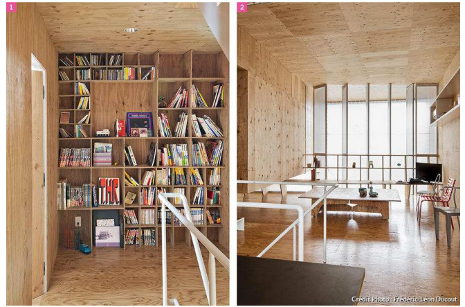
La bibliothèque du deuxième étage a été conçue en contreplaqué marine. Les meubles ont été réalisés par les premiers résidents en 2012, pour la plupart étudiants en architecture. Ils ont utilisé le même contreplaqué que celui des parois.
