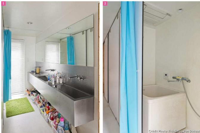
Dans la salle de bains collective, le lavabo en acier inoxydable est conçu pour faciliter l'utilisation par plusieurs personnes. En vis-à-vis, une baignoire peut être isolée au moyen de panneaux coulissants et d'un rideau.
